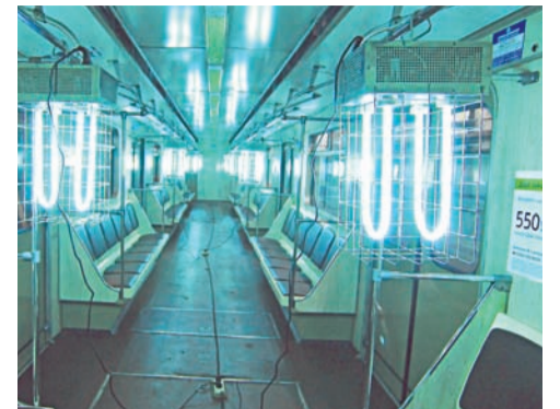
Воздух пройдет через ультрафиолетовые лампы в системе вентиляции
