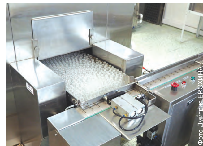
Флаканы отправляются в мощную машину, а оттуда – в чистую зону для розлива препарата
