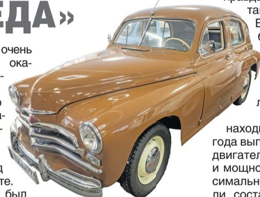
что ГАЗ М-20 – первый отечественный автомобиль, в котором был применен несущий кузов, а не рама. Обтекаемая форма кузова существенно улучшала аэродинамические свойства машины и делала ее легко узнаваемой. А вот независимая передняя подвеска, лонжероны, днище достались «Победе» от «Опеля».
