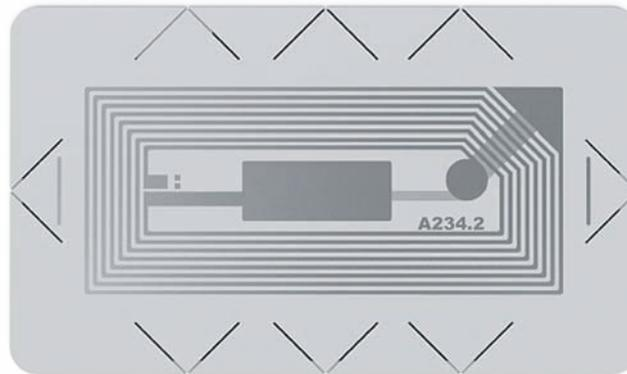
При попытке отклеить метку она расслаивается и перестает считываться
