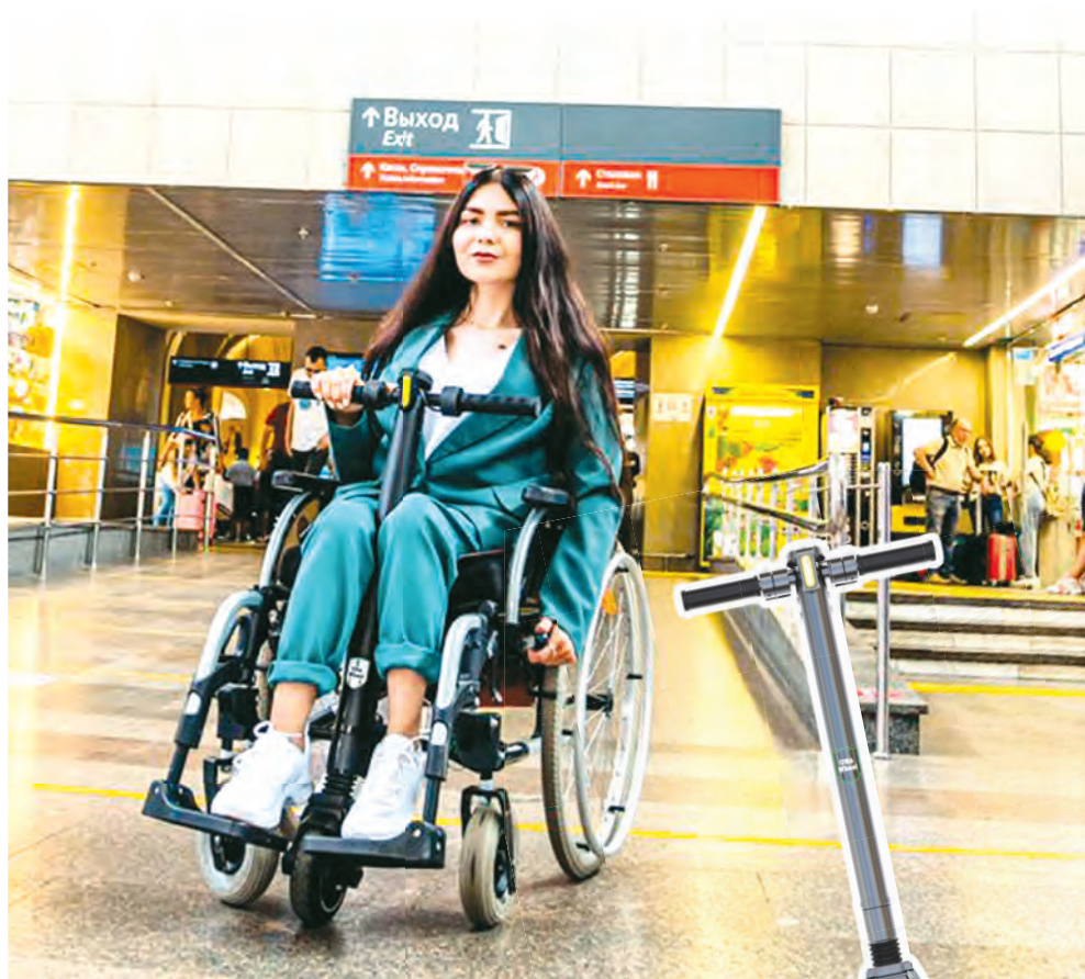
Легкая электрическая приставка UNAwheel для механических инвалидных колясок, разработанная командой под руководством Николая Юдина
