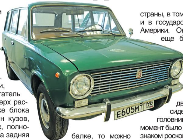
балке, то можно сложить сплошное заднее сиденье. При поездке вдвоем ВАЗ-2102 рассчитан на перевозку до 250 дополнительных килограммов. Это повлекло увеличение ширины покрышек и диаметра колес. Базовая модель «двойки» оснащалась 59-сильным карбюраторным двигателем с рабочим объемом 1,2 л, а в последующих модификациях эти характеристики выросли до 71 л.с. и 1,45 л. Разгон до сотни – за 22 секунды, максималь-
