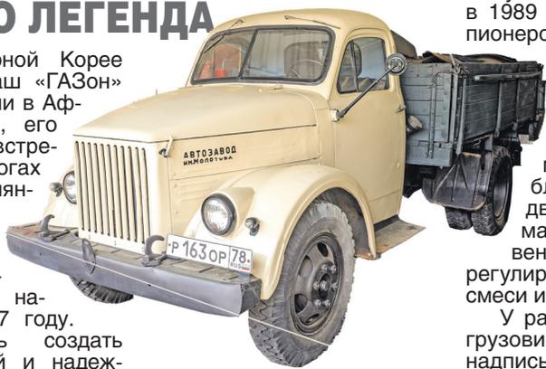
грузовиков ГАЗ он долгое время применялся в тягачах, автобусах и спецтехнике, а его выпуск закончился только в 1989 году. ГАЗ-51 стал пионером в реализации многих технологических решений (легкосъемные тормозные барабаны, алюминиевая головка блока цилиндров, двойная фильтрация масла, замкнутая вентиляция картера, регулируемый подогрев смеси и др.).
